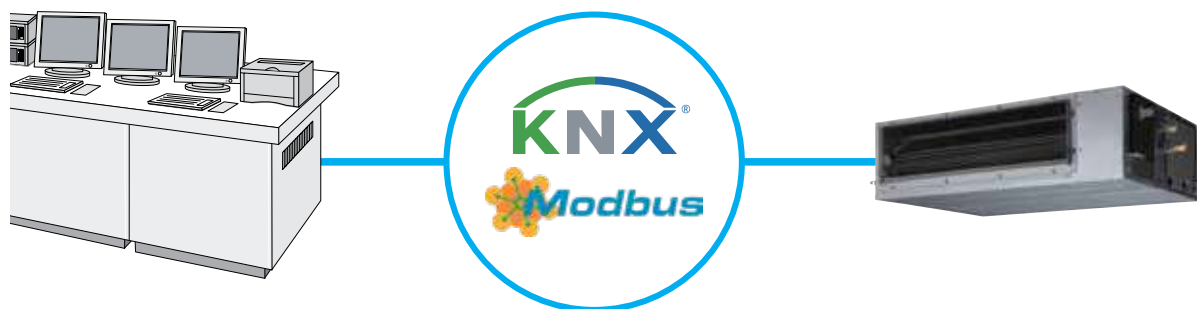
Σύστημα Κεντρικού Ελέγχου
