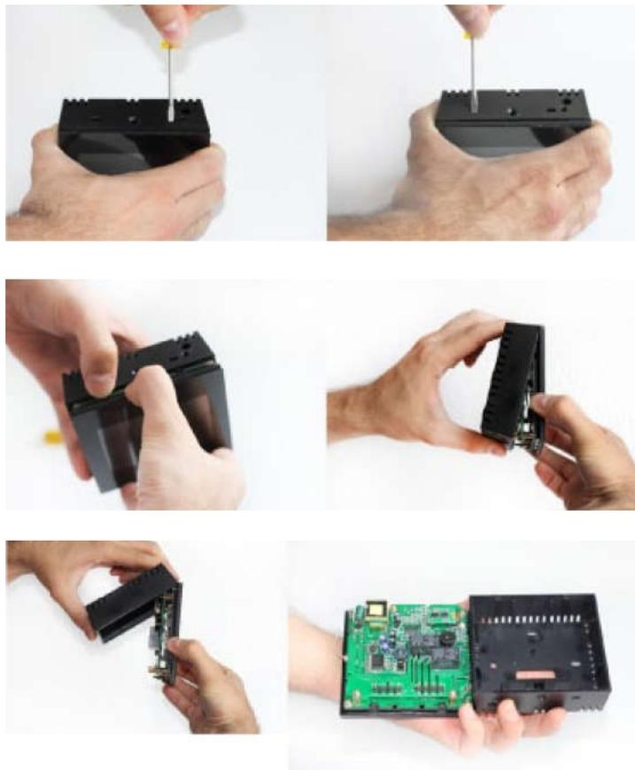
3 Αφαιρέστε το πίσω μέρος. Εκεί θα δείτε τις κλέμες για τα καλώδια σύνδεσης με τα συστήματα θέρμανσης και / ή κλιματισμού. Θα δείτε επίσης πολλά ανοίγματα για την στερέωση του θερμοστάτη στον τοίχο.
